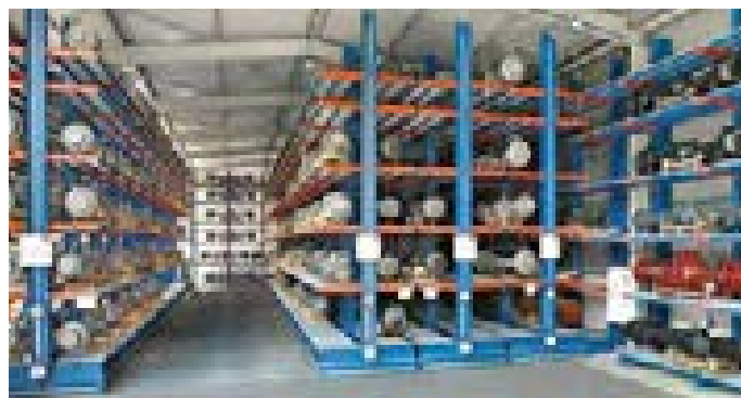
Installation de rayonnage mobile Augmentation de la capacité de stockage de 110 % = 21 rangées de rayonnages
